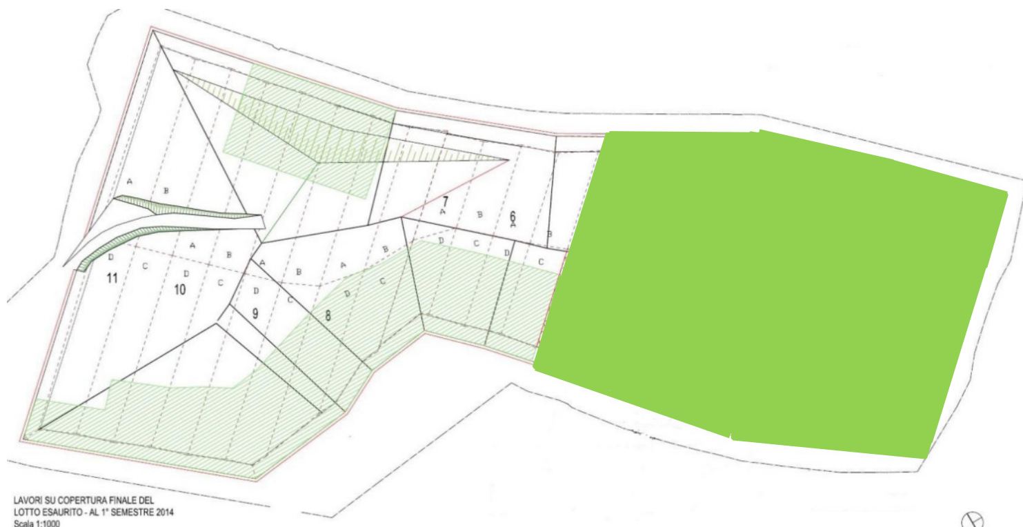
Fig. 7-6 Planimetria stato avanzamento lavori di copertura finale
